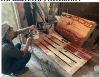
Fig 3. Epoxy Primer Painting
